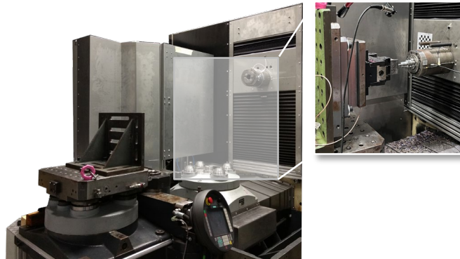
Deckel Maho, Typ DMC 60 H (wbk) – Horizontalfräszentrum, Baujahr: 1997
